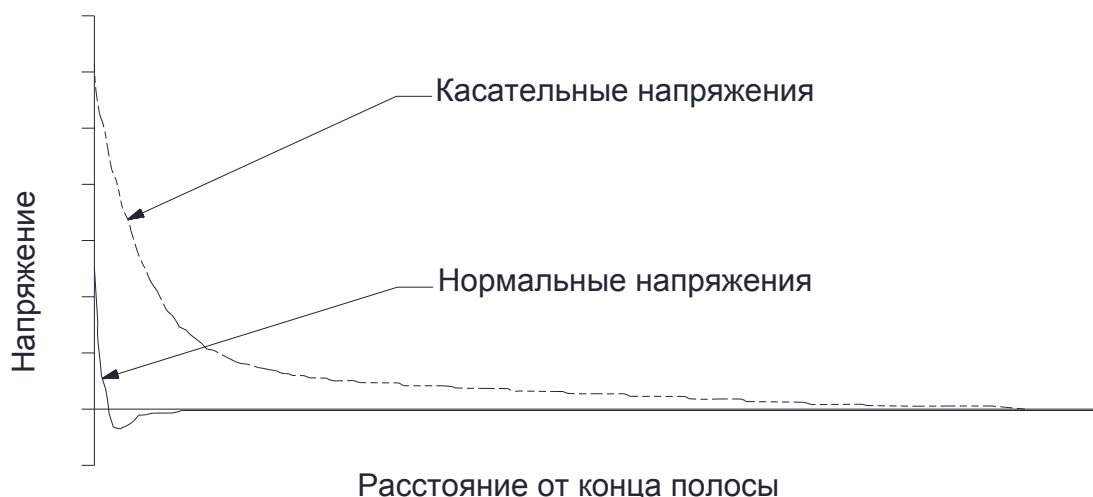
Рисунок 17 – Распределение нормальных и касательных напряжений на концевом участке полосы композиционного материала
